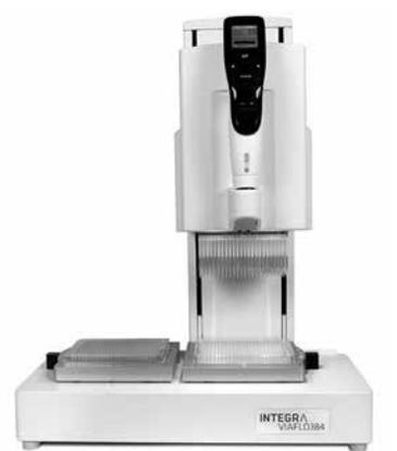
types de plaques 384 puits. VIAFLO 384 est d'une parfaite compatibilité avec les pointes de pipette VIAFLO GripTips qui offrent, à chaque utilisation, une parfaite étanchéité et ne tombent jamais en cours d'utilisation. Combiné aux nouvelles pointes extra-longues GripTips 12,5 µl, le système est totalement adapté pour traiter efficacement les blocs à puits profonds « Deepwell ».
